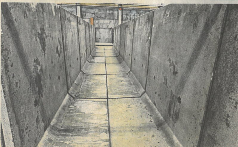
Durch diese Rinnen wird das Wasser rauschen: Im Institut für Wasserbau und Wasserwirtschaft ist der größte Kanal aus Beton, 30 Meter lang und zweimal zwei Meter breit. Hier kann man Deichbrüche simulieren. Fotos: Michael Jaspers
