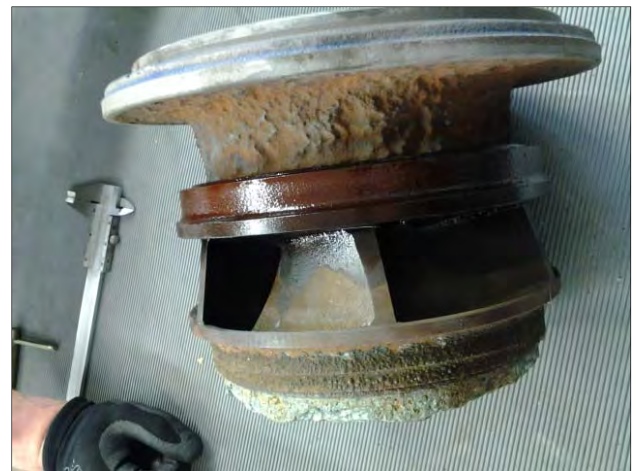
Abbildung 4: Inkrustationen an der Beckenwasserpumpe im Hallenbad Stolberg, Glashütter Weiher
