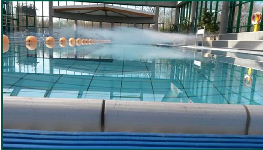
Abb. 3: Nebelversuch: Horizontale Schichtung
