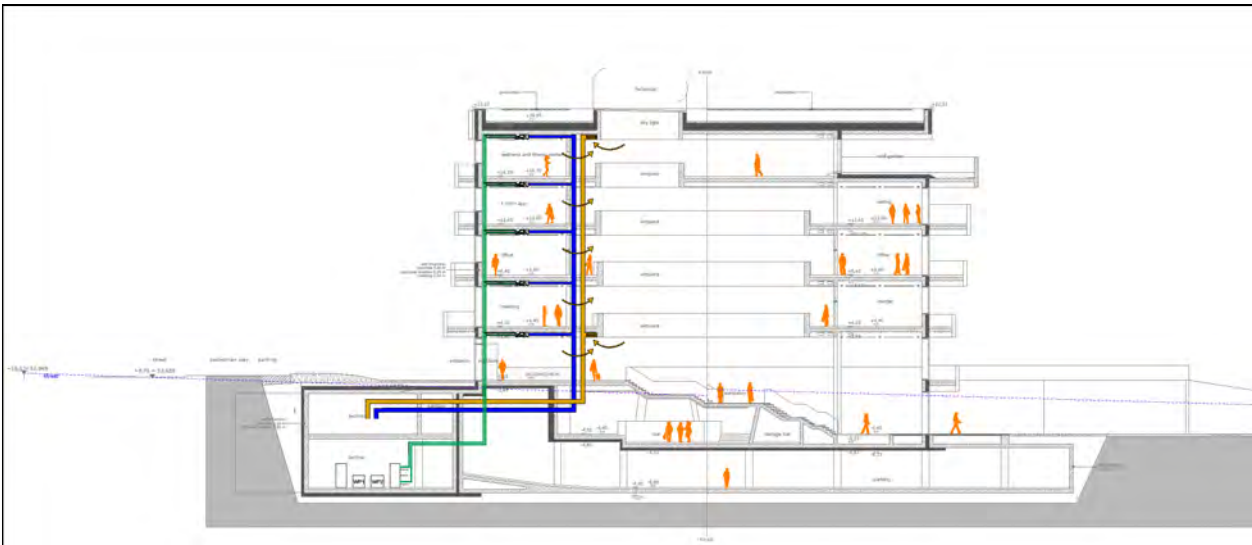
Abbildung 1: Übersichtsbild des Gebäudes mit allen technischen Anlagen
